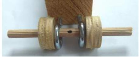
kleiner Stab (mit Loch) durch eine kleine Scheibe, dann durch beide Ringe und wieder durch eine kleine Scheibe stecken: siehe Foto, anschließend Scheiben fest bis an die Ringe schieben
